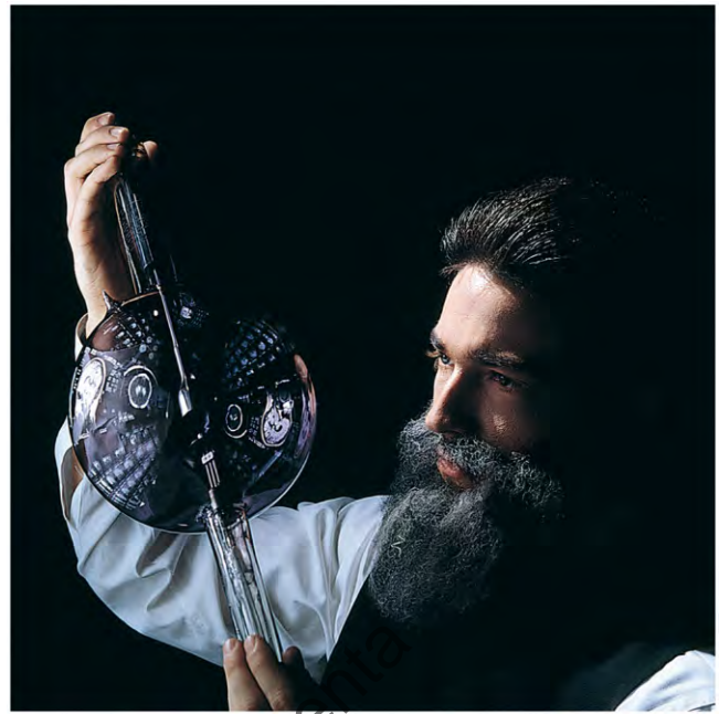
FIGURA 1.5 Muestra del tipo de tubo de Crookes utilizado por Roentgen cuando descubrió los rayos X. Los rayos catódicos (electrones) que dejan el cátodo son atraídos al ánodo por el alto voltaje, donde producen los rayos X y la luz fluorescente. (Cortesía de Gary Leach, Memorial Hermann Hospital.)
